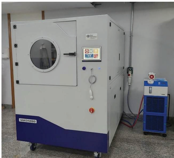
Figura 3 – Equipamento de Deposição de Metal a Vácuo, modelo VMD 1260.
