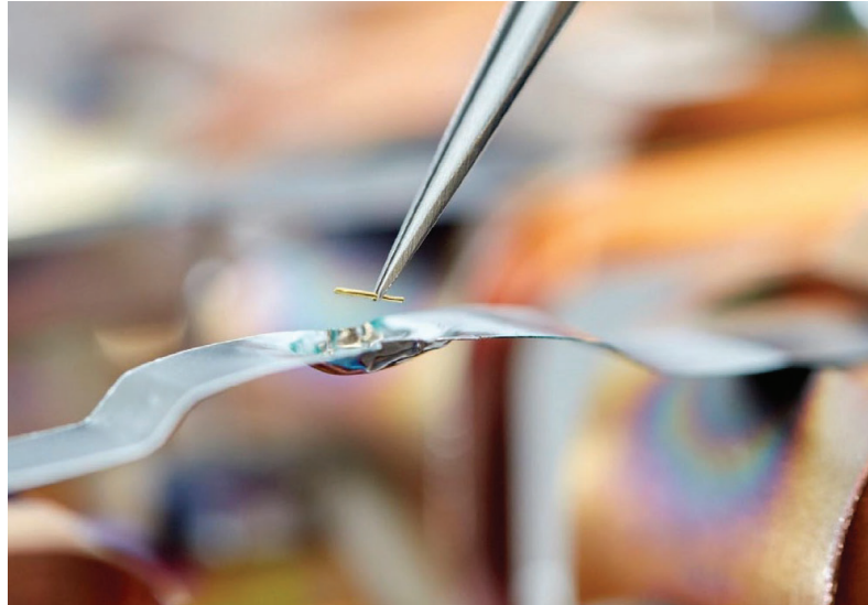
Figura 5 – Preparação do evaporador com fio de ouro. Fonte: Manual do usuário VMD 1260, 2023.
