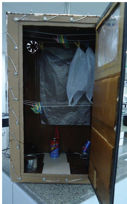
Figura 2: Câmara de cianoacrilato de baixo custo – interior. FONTE: Elaborado pelos autores, 2024.
