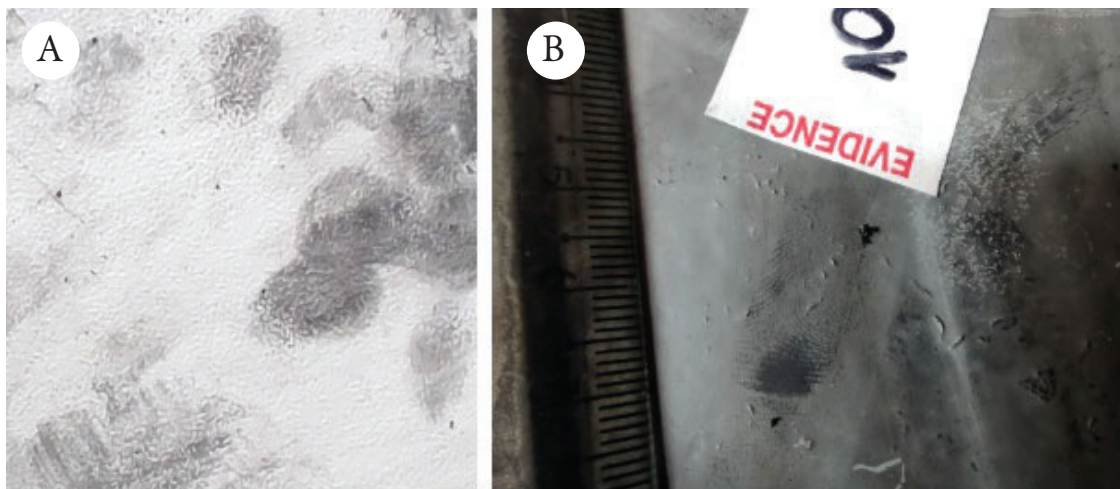
Figura 03: Impressões digitais reveladas em cofre com uso de pó regular e magnético Legenda: A) Marcas papilares reveladas com pó regular; B) Marca papilar revelada com pó magnético. Fonte: Acervo pessoal, 2023.
