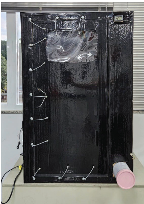
Figura 1: Câmara de cianoacrilato de baixo custo – exterior. FONTE: Elaborado pelos autores, 2024.
